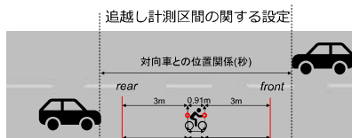
図-5 追越し計測区間の概要
