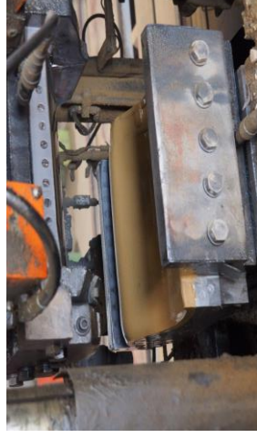
瓦の成形 プレス機に設置された金型で粘土を成形する工程
