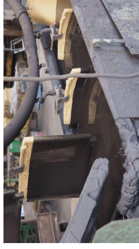
施釉 成形後、瓦を乾燥させ、乾燥した白地（焼く前の瓦）に釉薬を施す工程
